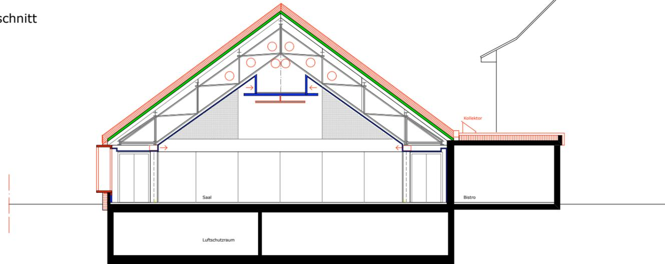
Querschnitt mit Sicht auf Raumtrennsystem
